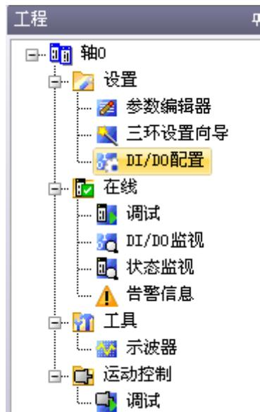
在弹出的界面中点击位置模式下想要作为触发点的端子，如下图的 DI11，在弹出的“选择端子功能”页面中点击“PT\_TRIG”，这样就将 DI11 配置为位置模式下的 PT\_TRIG 信号
